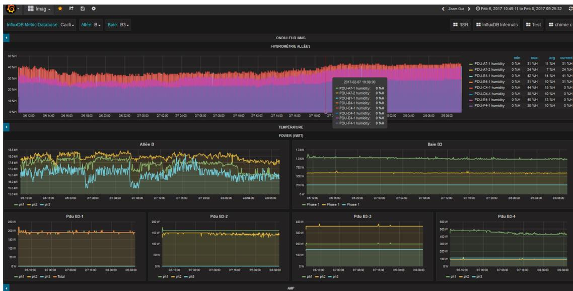
Figure 2 - Exemple de monitoring avec grafana
