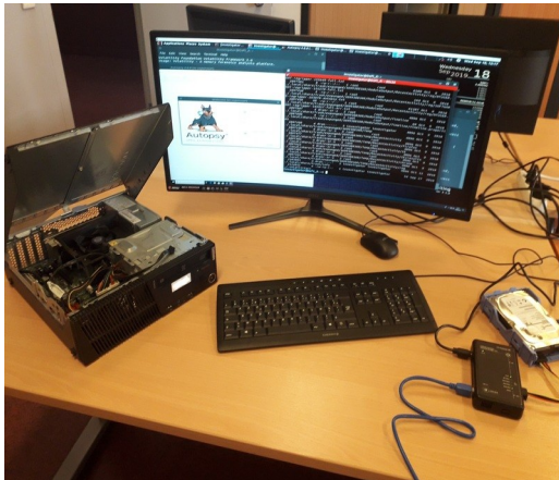
Figure 3 : Analyse forensique sur un disque réalisée à l'aide d'un bloqueur en écriture
